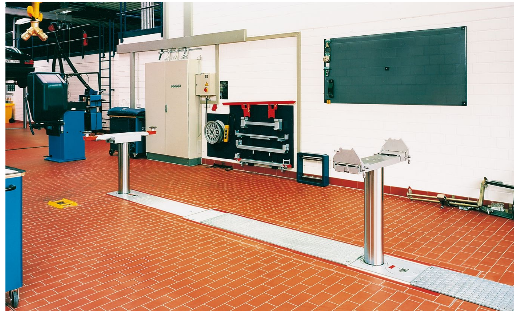
Abbildung: Zwei-Stempel-Hebebühne, Tragfähigkeit 8.000 kg pro Heberzylinder.
