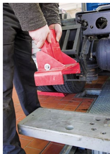
Auswechselbares Aufnahme-Schieber-System zum Anheben verschiedener Fahrzeugtypen.
